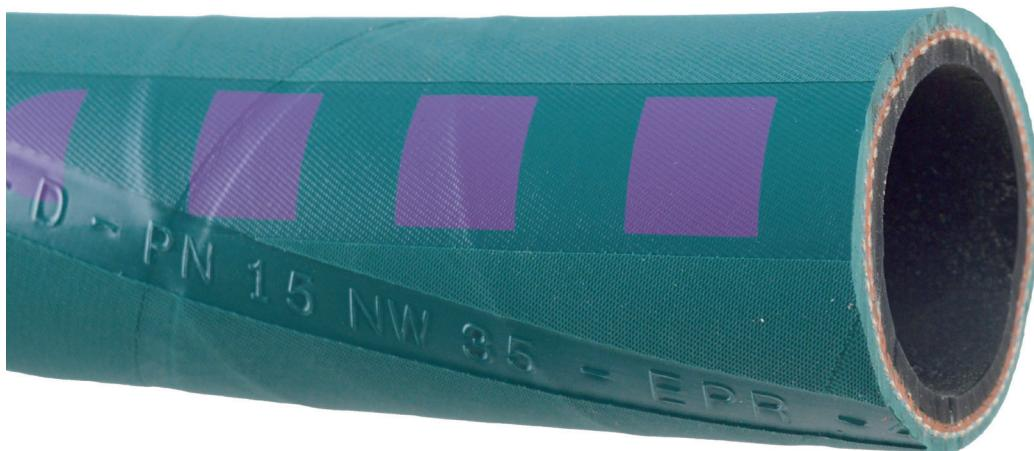
Robuste, strapazierfähige, flexible Gummidruckschläuche, dorngewickelt, antistatisch durch eine Kupferlitze.
