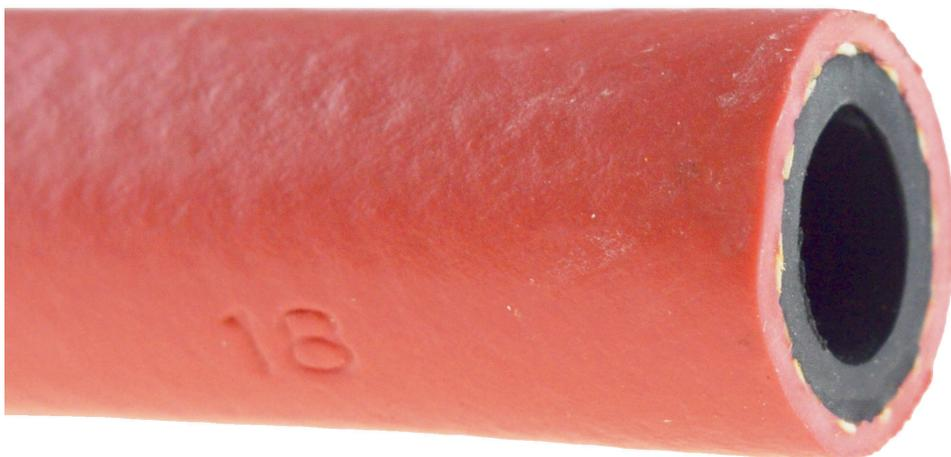
Extrudierter Gummi-Druckschlauch / Acetylenechlauch nach EN ISO 3821 (EN 559) mit Gewebeeinlage. Zum Transport von Acetylen. Zum Schweißen und Schneiden, zum Bogenschweißen unter Schutzgas und für ähnliche Verfahren. Auch geeignet für Wasserstoff, Leuchtgas, Argon, Stickstoff zum Schweißen und Schneiden. Nicht geeignet für LPG, MPS und CNG!
