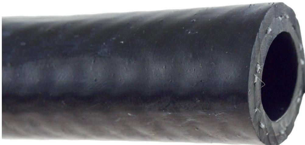
Spezieller Vielzweckwasserschlauch für den Einsatz an Heizregistern oder sonstigen Kreisläufen. Durch die spezielle Innenseele aus Butylkautschuk ist dieser Schlauch überall dort einsetzbar, wo diffusionsarme Leitungen gefragt sind. Die Decke aus EPDM verschafft dem Schlauch von außen eine sehr gute Haltbarkeit von außen.
