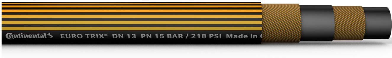
**KENNZEICHNUNG:** 6 orangefarbene, axial verlaufende Streifen auf schwarzem Untergrund "Continental EURO TRIX® DN 13 PN 15 BAR / 218 PSI Made in Germany"
