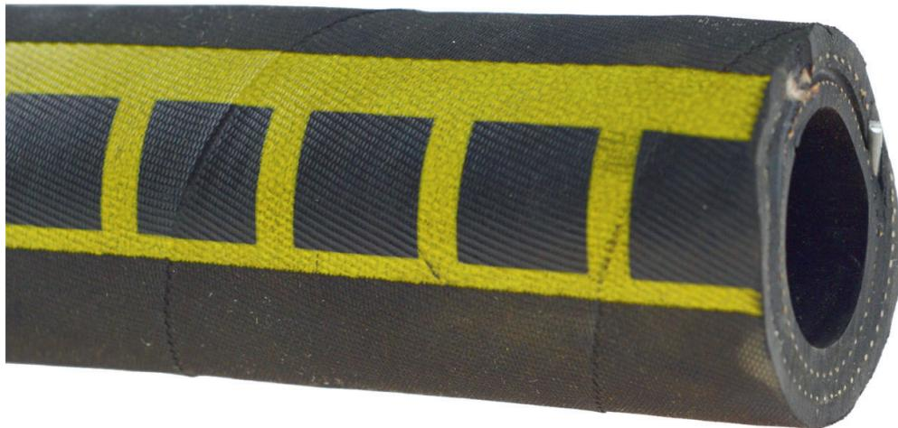
Tankwagenschlauch, schwerer Gummispiralsaug- und Druckschlauch, dorngefertigt und flexibel. Vakuum gem. Norm -0,9 bar und hohen Betriebsdruck, Schlauchdecke antistatisch ausgerüstet, Widerstand kleiner als 106 Ohm. Nach EN 12115:11 und TRbF 131/2.
