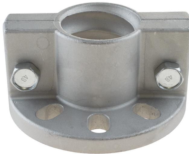
Die Muffenkupplung ist ein leichtes Flanschverbindingssystem aus Aluminium für eine schnelle und einfache Montagefertigung vor Ort. Zwei identische Halbschalen werden mechanisch mit Schrauben am Wellschlauch befestigt - speziell entwickelt für eine perfekte Passform mit dem außen gewellten ALFATRACTO 719AA Materialförderschlauch.
