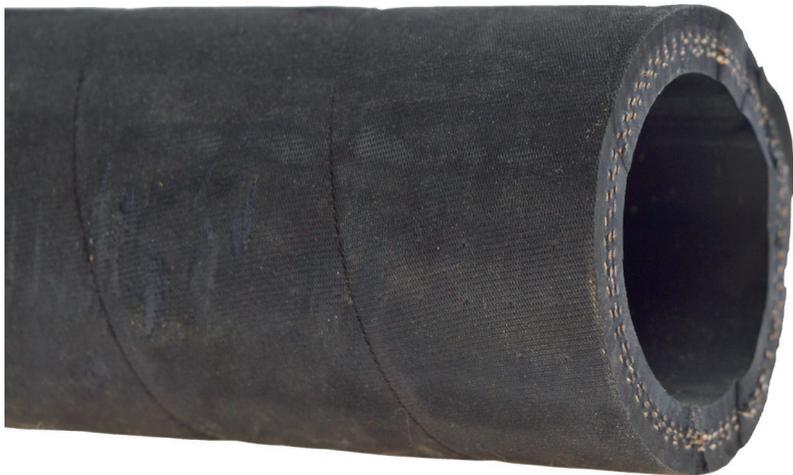
Schwerer, flexibler, langlebiger Gummidruckschlauch, dorngefertigt, für Dampf und heißes Wasser. Nach EN 6134/5, Typ 1, Klasse A - 6 bar Dampfdruck, 10-fache Sicherheit. Innendurchmesser 5 mm außen hellgrau, für Dampfbügler, 8-fache Sicherheit.
