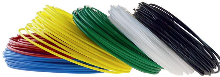
Der PA 12 ist halbstarr, gut verlegbar und knickstabil. Er wird bevorzugt bei Druckluftleitungen, Druckluftbremsleitungen, Hydraulikleitungen und Kraftstoffleitungen eingesetzt. Seine Vorteile sind der hohe Betriebsdruck, die gute mechanische Widerstandskraft, die gute chemische Resistenz und die Schleppkettentauglichkeit. Er ist ideal für Vakuumanwendungen. Eine ausreichende UV-Beständigkeit ist nur bei schwarzer Einfärbung möglich.
