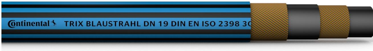
**KENNZEICHNUNG:** 6 blaue, axial verlaufende Streifen auf schwarzem Untergrund "Continental TRIX BLAUSTRAHL DN 19 DIN EN ISO 2398 3C / L-T LUFT/AIR 2,5 MPa (25 BAR / 363 PSI) Ω-CL Ölkanne Made in Germany"
