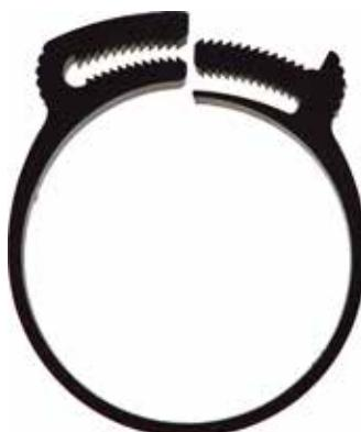
Schnapp-Schlauchschellen eignen sich bestens zur schnellen und einfachen Befestigung leichter, glattwandiger Schläuche auf Schlauchtülle, Rohrenden oder Gewindeenden. Die Montage gelingt einfach mit einer Zange und lässt sich ebenso leicht durch seitliches Auseinanderschieben der Verzahnung wieder lösen.
