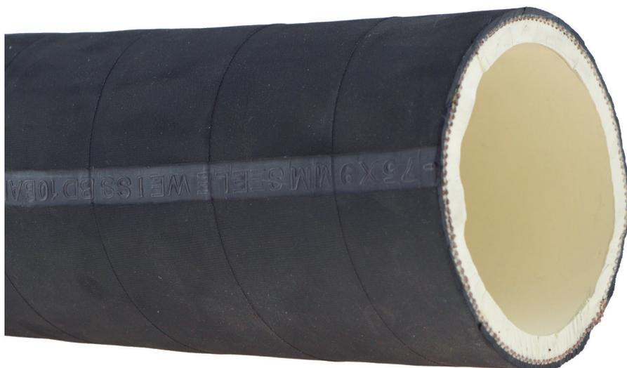
Schwerer, flexibler, langlebiger Gummidruckschlauch, dorngewickelt, zum Be- und Entladen von Silotransportfahrzeugen. Geeignet zum Fördern von festen und abrasiven Lebensmitteln und Tierfutter.
